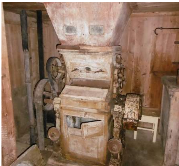
Wnętrze młyna. Mlewnik firmy Ganz Danubius, rok prod. 1888–1892 – stan przed remontem, pocz. XXI w.
